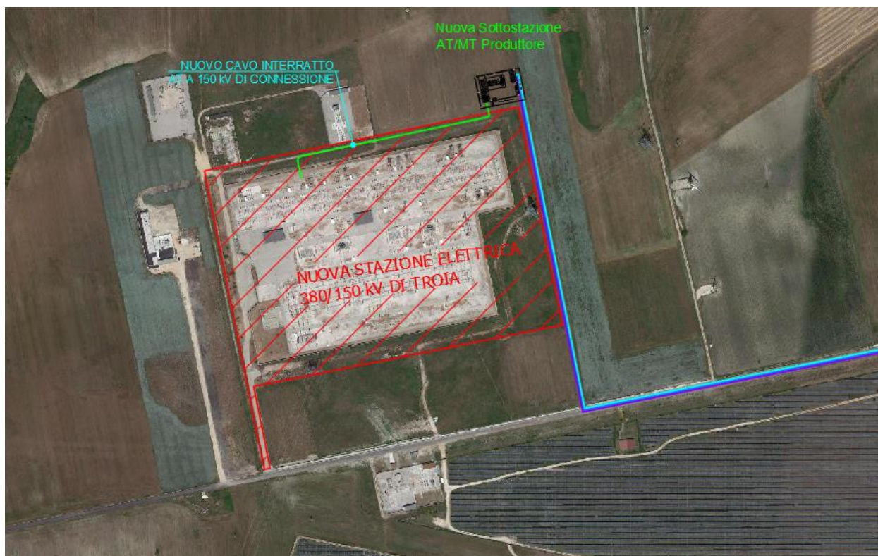
Stazione Terna – Troia (FG)
