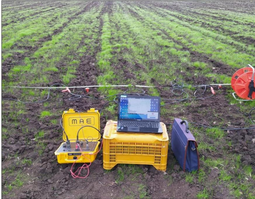
Fig. 9 Esecuzione indagine MASW (strumentazione per acquisizione dati).
