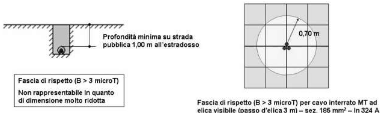
Fascia di rispetto per un cavo MT 3x1x185 mm 2 ad elica visibile
