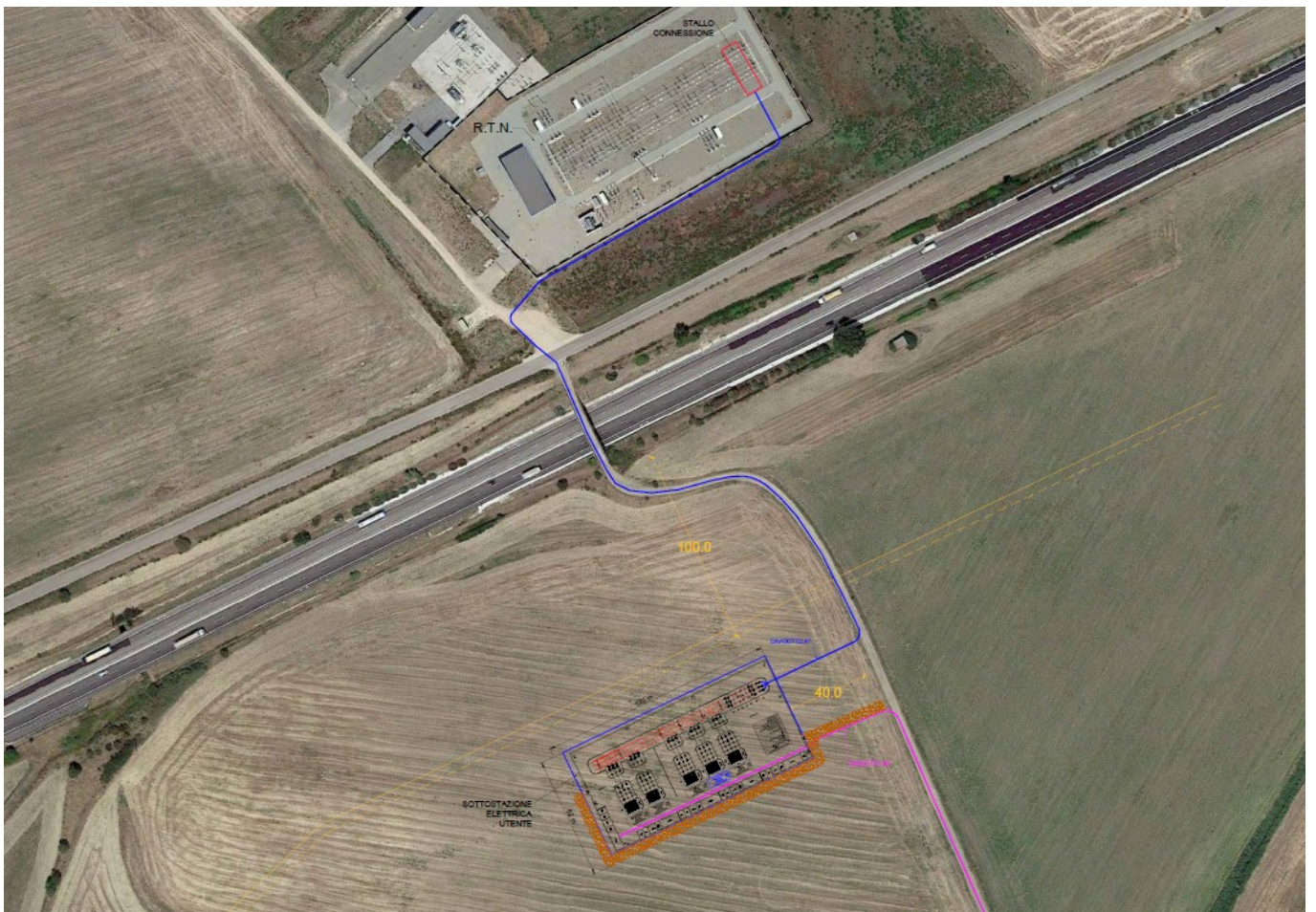
Indicazione dello Stallo AT di arrivo nella Sottostazione Terna.
