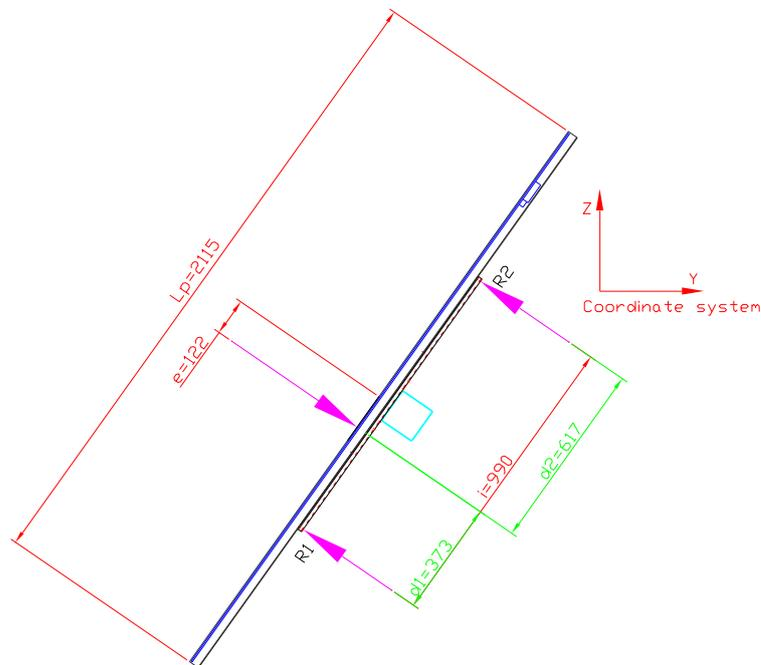
Il calcolo delle reazioni R1 e R2 dovute all'eccentricità del carico sono ricavate dalle seguenti formule:
