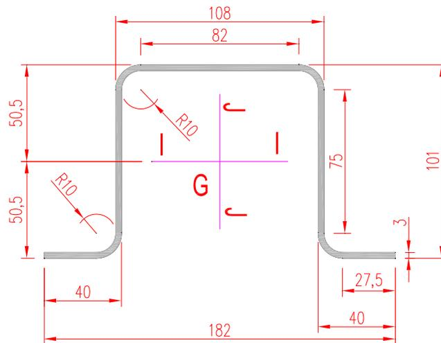
*Caratteristiche inerziali (dimensioni espresso in mm):*
