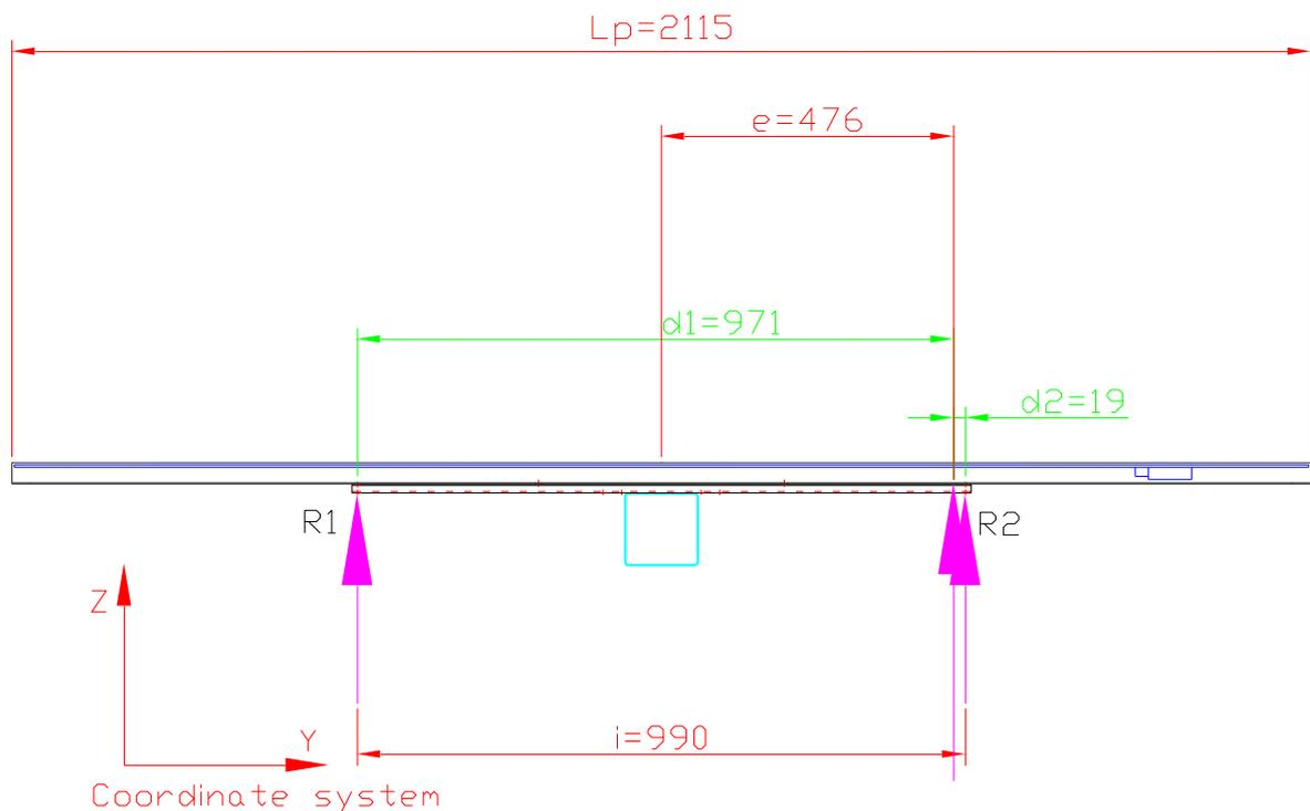
Il calcolo delle reazioni  $R_1$  e  $R_2$  dovute all'eccentricità del carico sono ricavate dalle seguenti formule:
