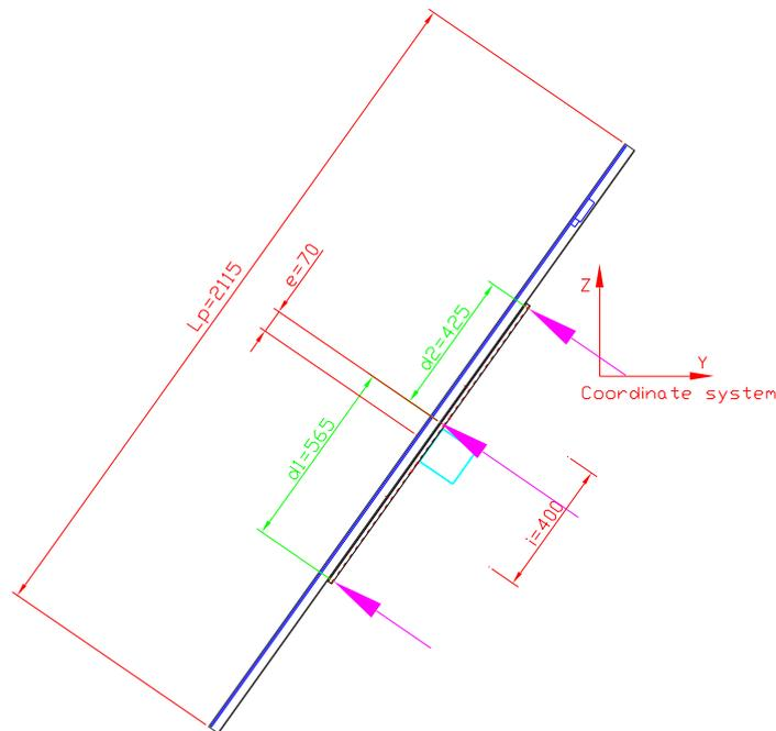
Il calcolo delle reazioni R1 e R2 dovute all'eccentricità del carico sono ricavate dalle seguenti formule:
