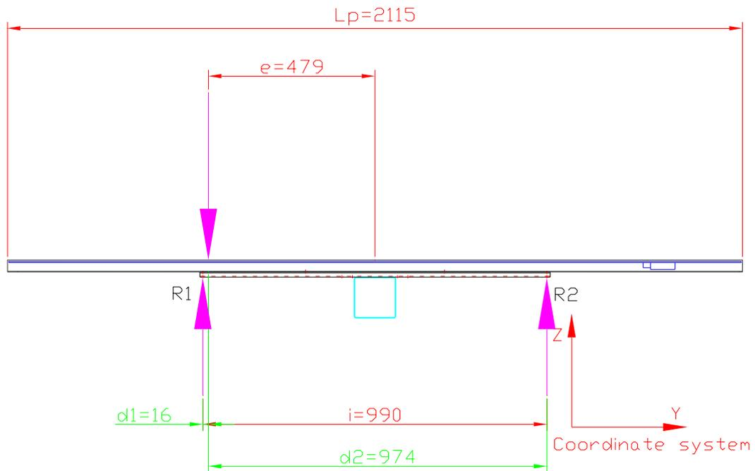
Il calcolo delle reazioni  $R_1$  e  $R_2$  dovute all'eccentricità del carico sono ricavate dalle seguenti formule:
