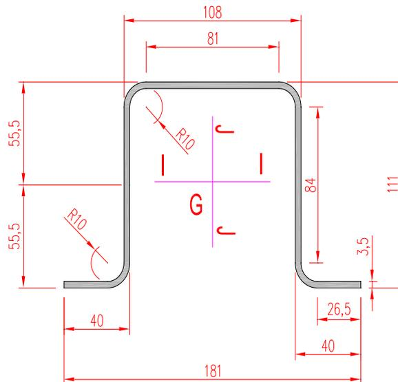
*Caratteristiche inerziali (dimensioni espresso in mm):*
