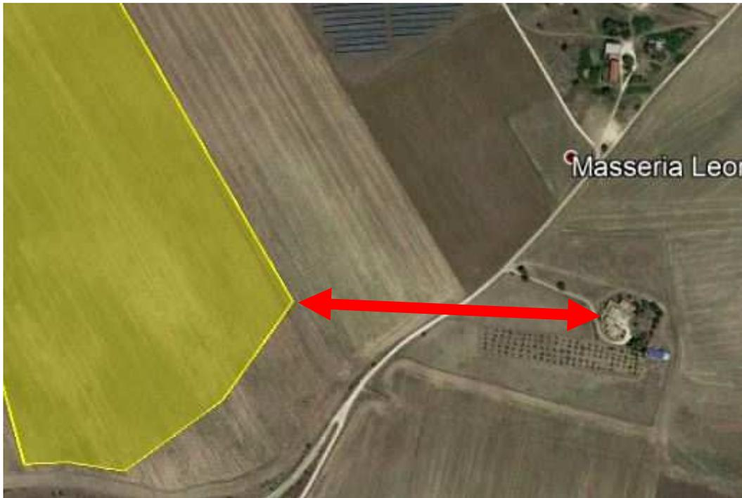
Il ricettore sensibile più vicino all'impianto fotovoltaico è rappresentato da un'abitazione rurale. La freccia in rosso mostra la notevole distanza (superiore ai 325 metri) che divide l'edificio dalla cabina inverter, rendendo assolutamente nulla la percezione del rumore.
