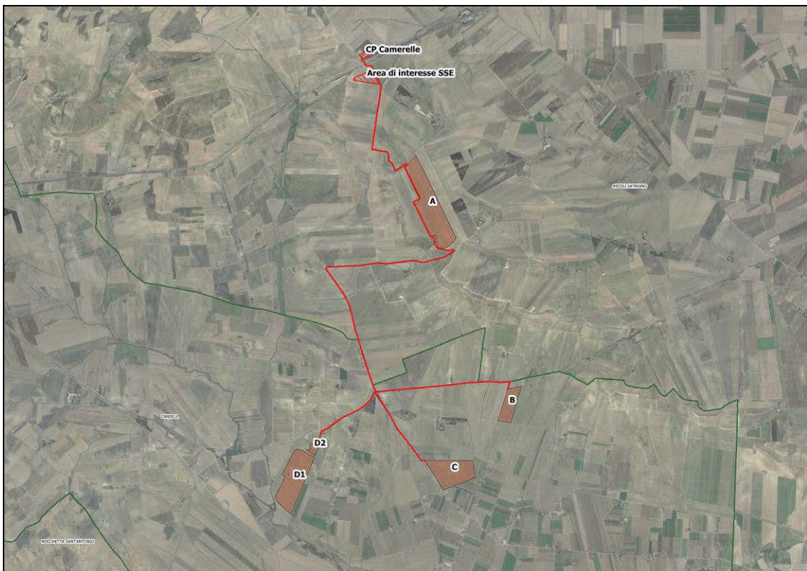
Fig. 2 – Planimetria generale dell'impianto fotovoltaico su base ortofoto
