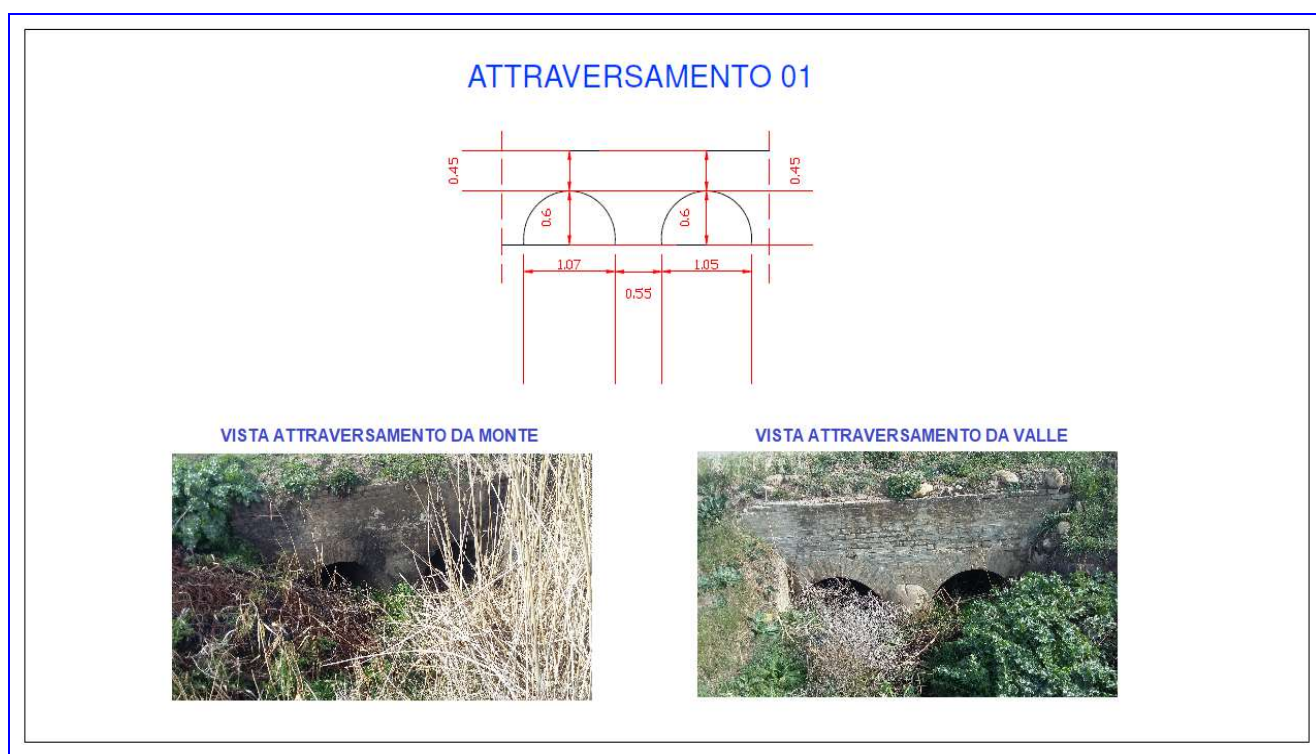
Fig. 13: Esempio di rilievo per l'attraversamento n° 01.
