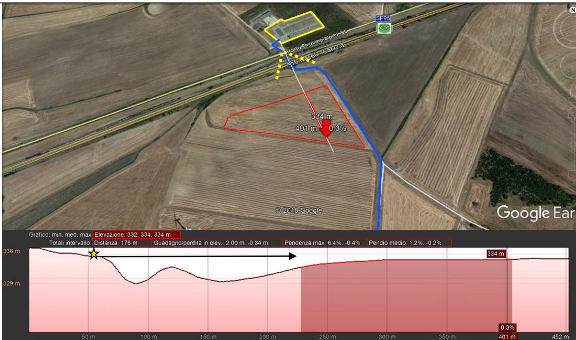
**Figura 4 – Profilo longitudinale lungo la visuale da un punto di vista lungo la SP95 verso la sottostazione elettrica Utente**
