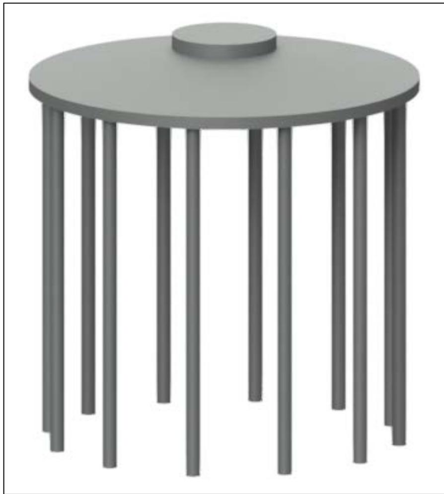
Figura 4: vista tridimensionale della fondazione dell'aerogeneratore
