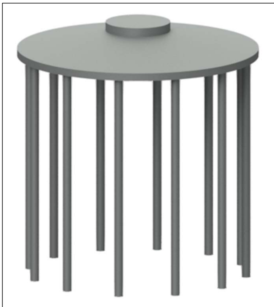
Figura 1: vista tridimensionale della fondazione dell'aerogeneratore
