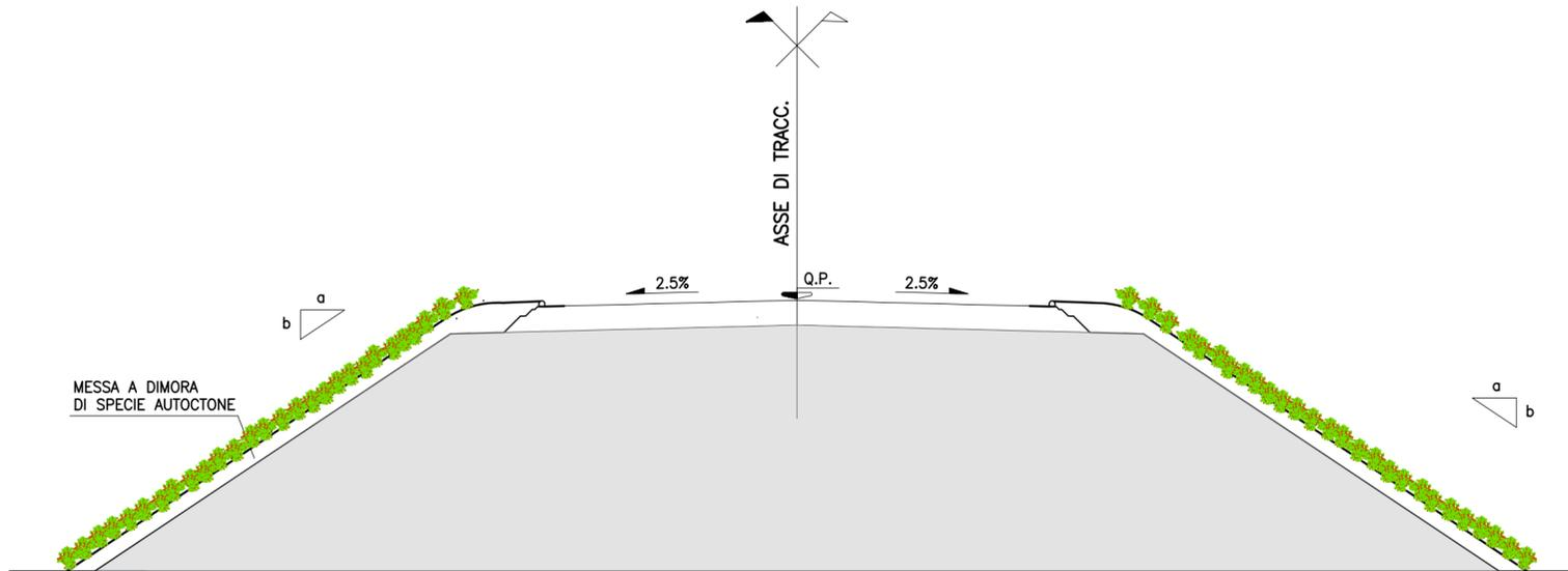
SISTEMAZIONE A VERDE SEZIONE TIPO IN SCAVO
