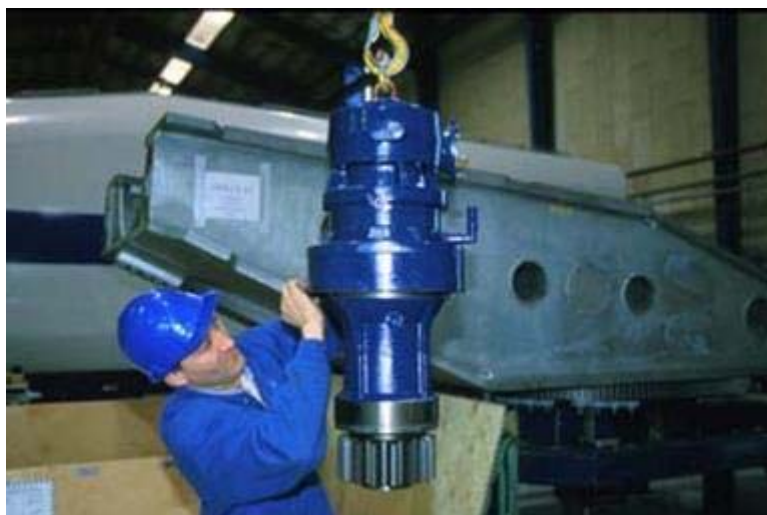
Figura 6: motori di giro e riduttori
