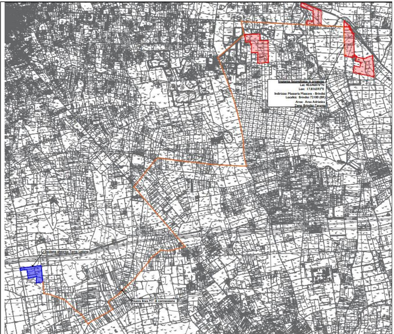
Figura 8: CTR con individuazione dell'elettrodotto da realizzare (colore arancione)
