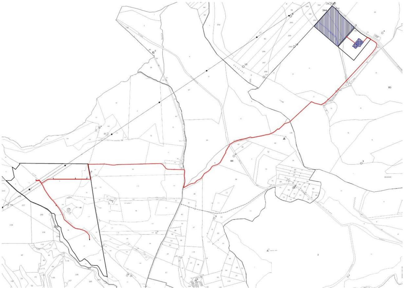
**Figura 1** - Percorso dell'elettrodotto interrato MT da realizzare (tratto in rosso)
