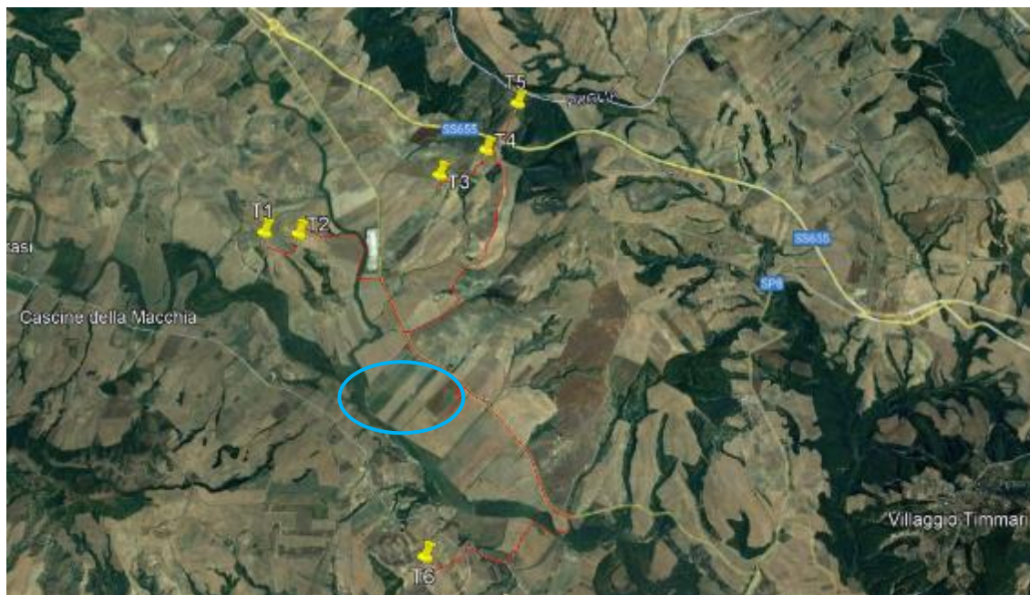
Figura 4 - Ubicazione Stazione di rete e tracciato cavidotto
