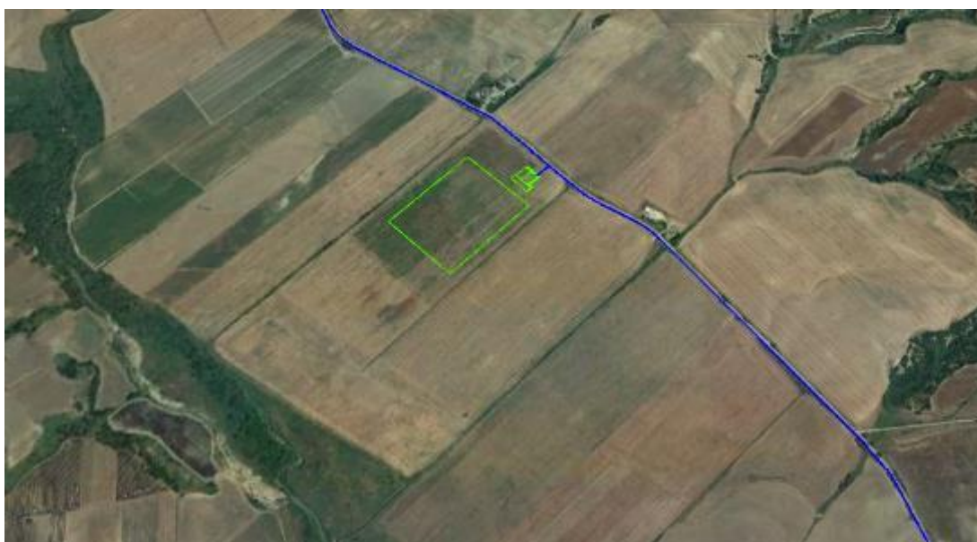
Figura 62 - Ubicazione Stazione di rete e tracciato cavidotto
