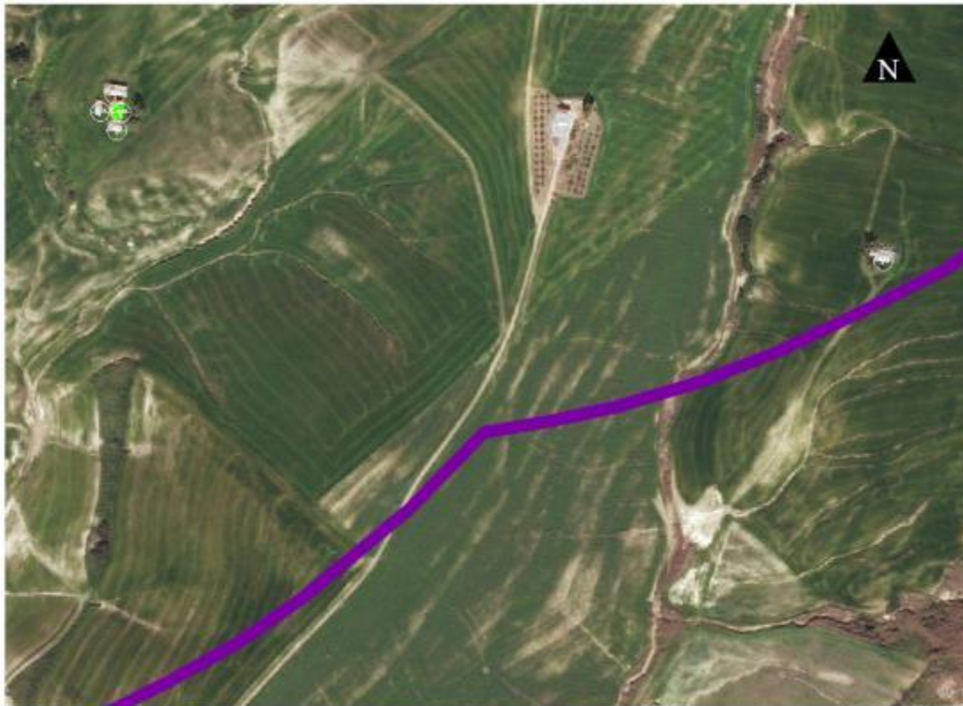
Figura 3-6 Esempio di censimento ricettori: residenziali (verde), depositi agricoli (grigio) all'interno dell'ambito di studio (viola)
