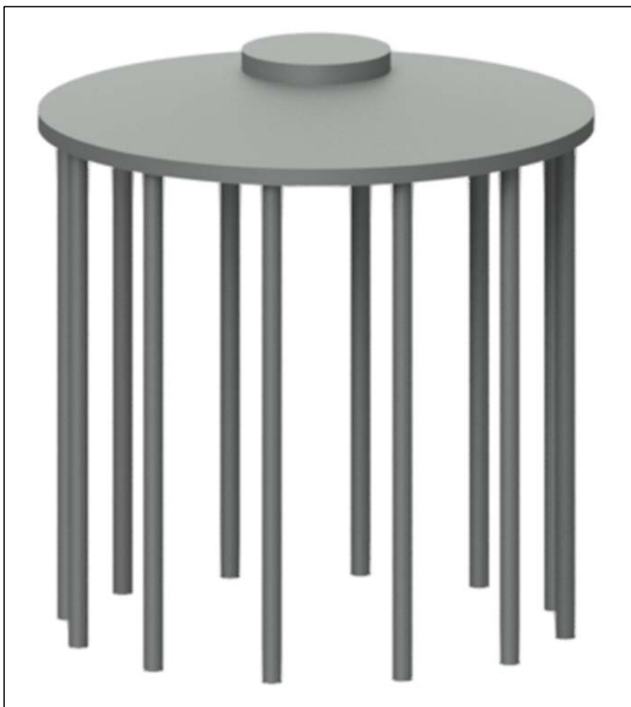
Figura 1: vista tridimensionale della fondazione dell'aerogeneratore
