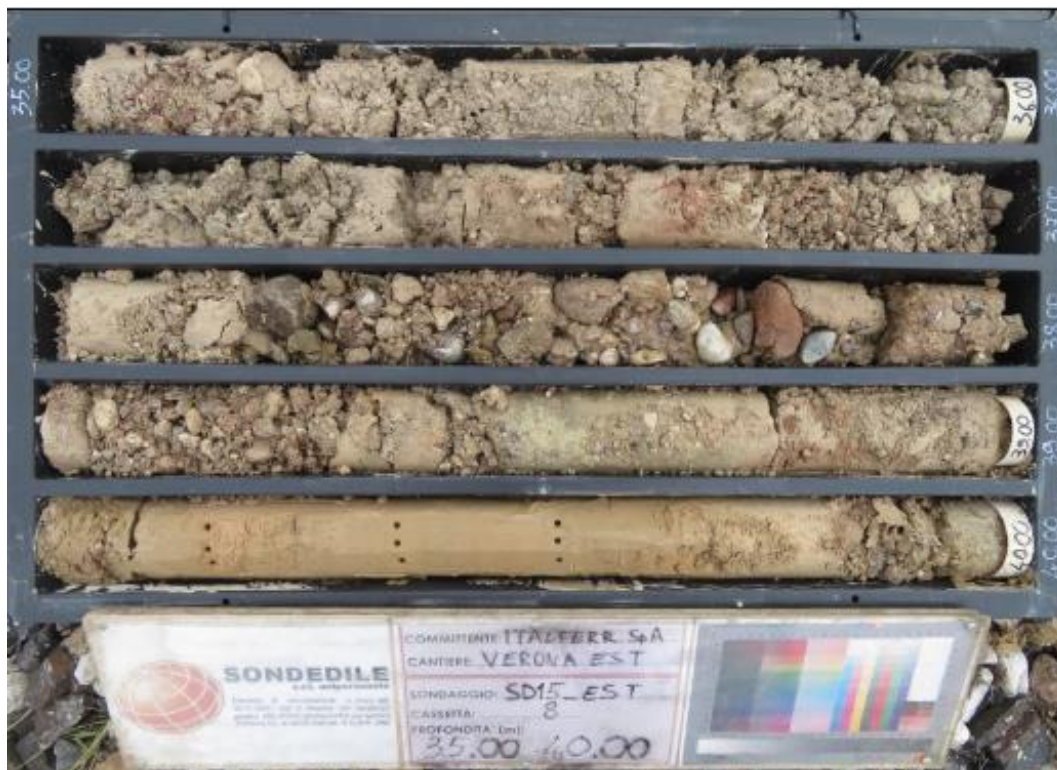
Figura 11. Sondaggio SD5 della campagna geognostica ITALFERR 2021: unità fg R2 , 38.40÷40.00 m; il materiale si presenta prevalentemente sabbioso-limoso
