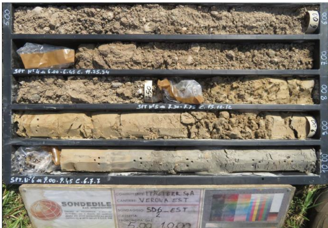
Figura 16. Sondaggio SD7, Campagna geognostica ITOLFERR 2021, unità bn1 (ghiaie), intercalazione dell'unità bn2 (sabbie), 7.00-8.00 m
