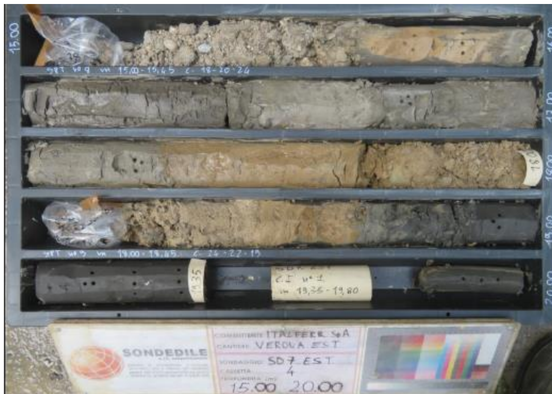
Figura 17. Sondaggio SD7, Campagna geognostica ITALFERR 2021, unità bn3 e bn4 (limoso-argillosa), 15.60-20.00 m
