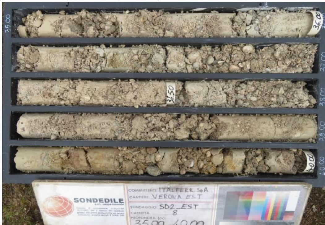
Figura 10. Sondaggio SD2 della campagna geognostica ITALFERR 2021 eseguito in prossimità dei capannoni di Trenitalia: unità fg R21 , a profondità maggiori di 35 m da p.c., ricca di ciottoli poligenici ed eterometrici ( \varnothing max >6 cm), da angolari ad arrotondati, in matrice sabbiosa e sabbioso-limosa di colore avana
