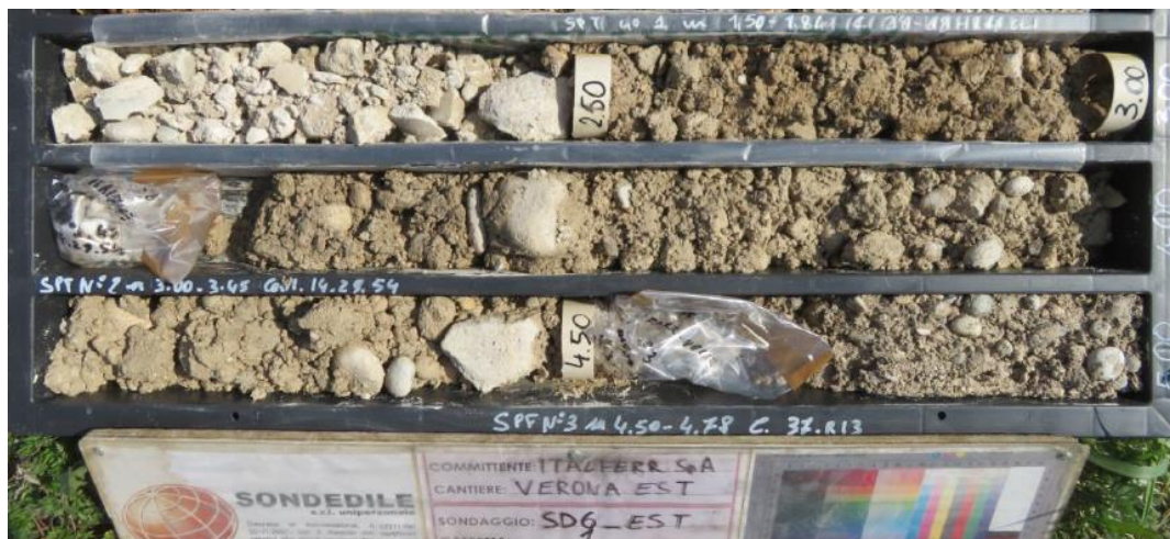
Figura 18. Sondaggio SD6, Campagna geognostica ITALFERR -2021, unità bb; nella cassa 1 da 2 fino a 5.00 m si nota ciottoli eterometrici in matrice sabbiosa di colore avana.
