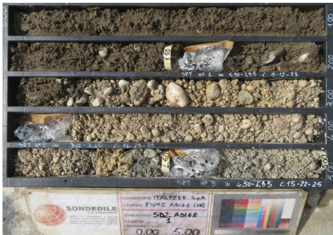
Figura 19. Sondaggio SD2Adige, Campagna geognostica ITALFERR -2021, unità ba; nella cassa si nota oltre a ciottoli eterometrici ed un alto contenuto di matrice di sabbia
