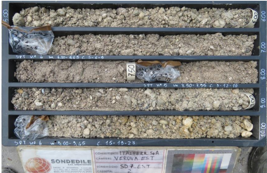
Figura 15. Sondaggio SD7, Campagna geognostica ITOLFERR 2021, unità bn1 (ghiaie), intercalazione dell'unità bn2 (sabbie), 7.00-8.00 m
