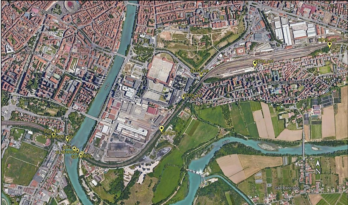
Figura 2-2 - Ubicazione dei sondaggi SPT
