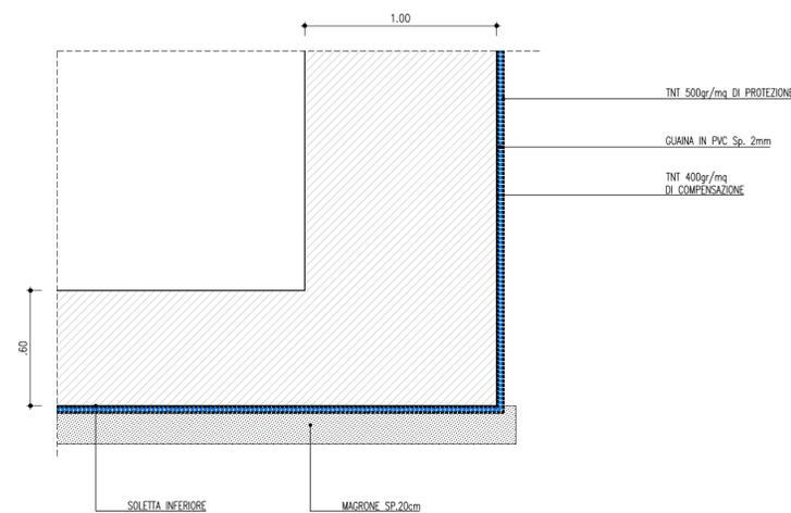
ELEMENTI WATER-STOP PER IMPERMEABILIZZAZIONE IDRAULICA DEI GIUNTI
