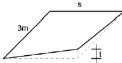
**Fig. 5.2.14 - Sghembo ammissibile**
