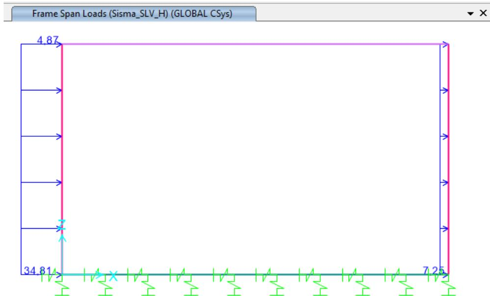
Fig. 14 – Sisma SLV\_H – Forze inerziali orizzontali
