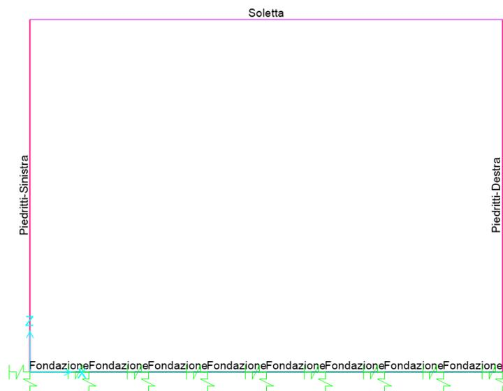
**Fig. 4 – Modellazione unifilare dello scatolare**
