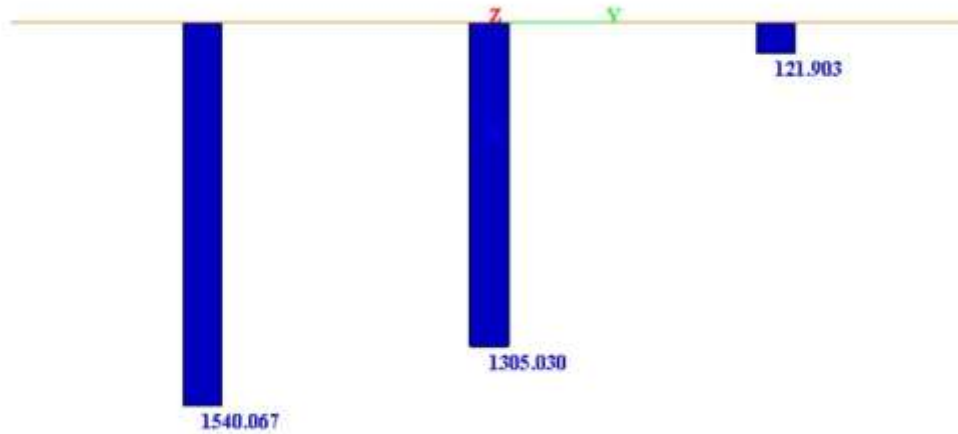
Figura 11-3: Diagrammi di momento flettente, taglio e azione assiale lungo i pali - Combinazione SLV ( k_v negativo)
