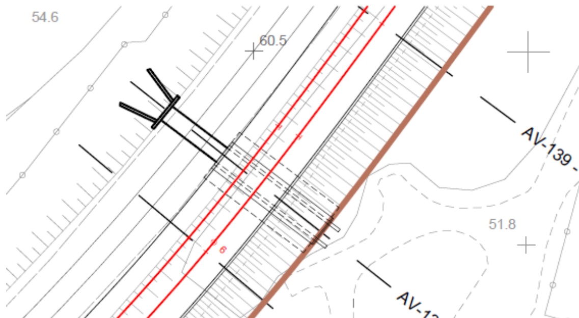
Figura 4 – Planimetria dell'intervento del sottovia ferroviario
