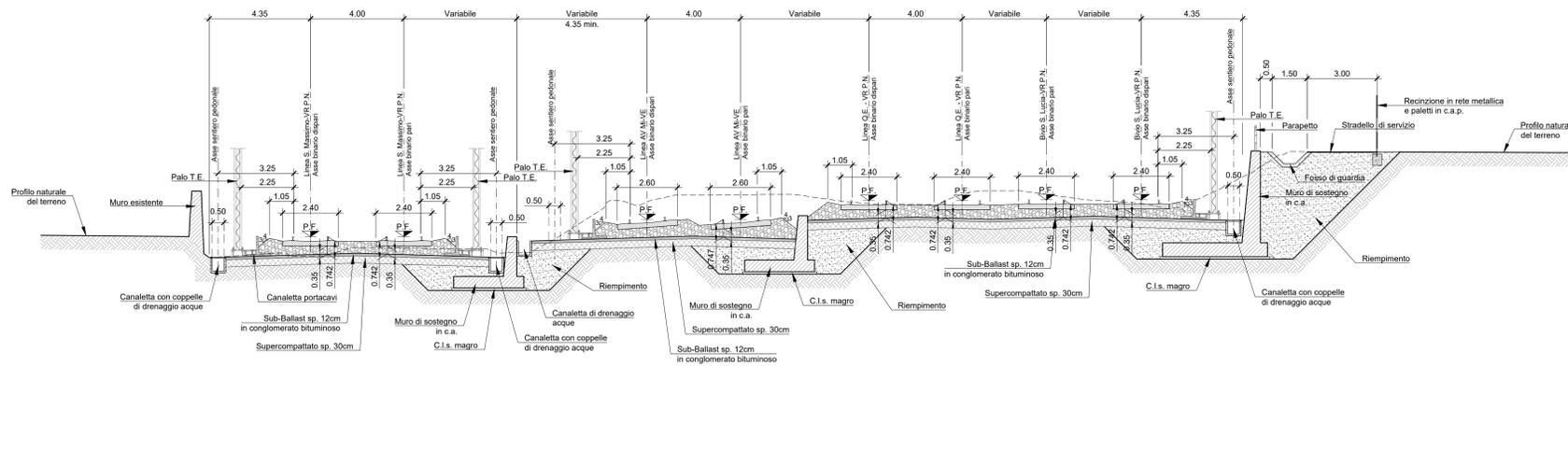
**SEZIONE TIPO IN RILEVATO H<6.00m**
