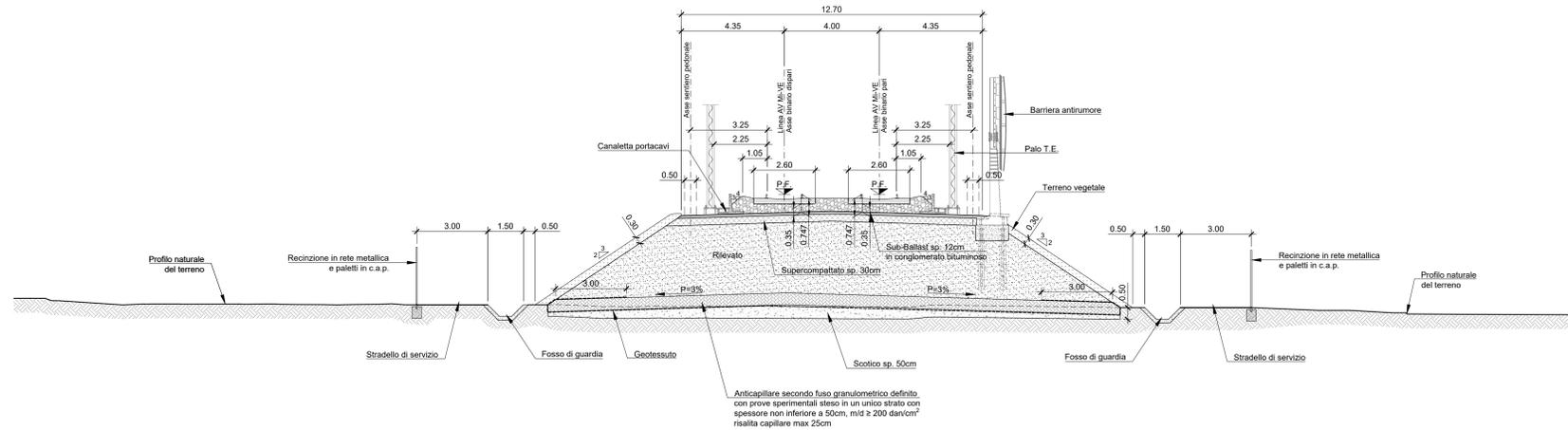
SEZIONE TIPO IN RILEVATO H>6.00m
