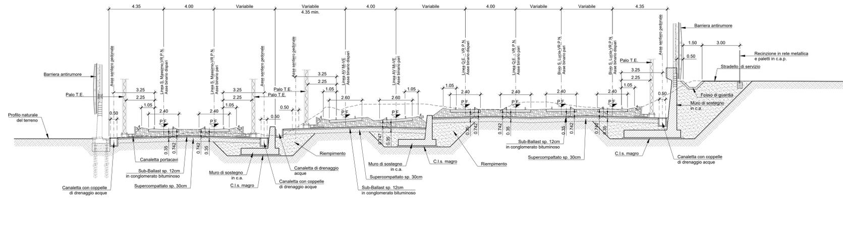
SEZIONE TIPO IN RILEVATO H<6.00m
