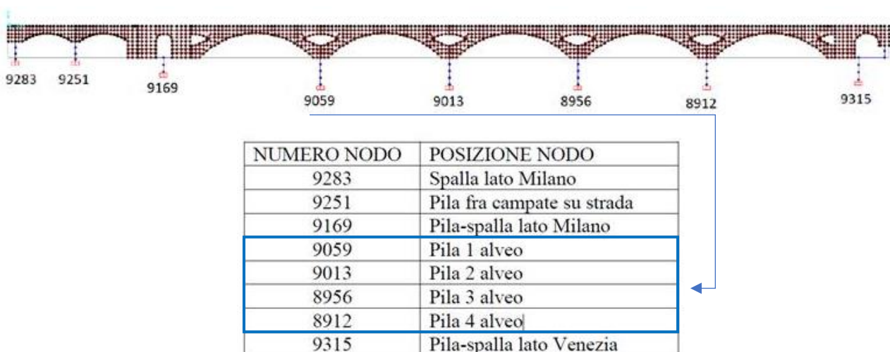
Figura 2 - Prospetto del modello di calcolo globale con individuazione dei nodi di base
