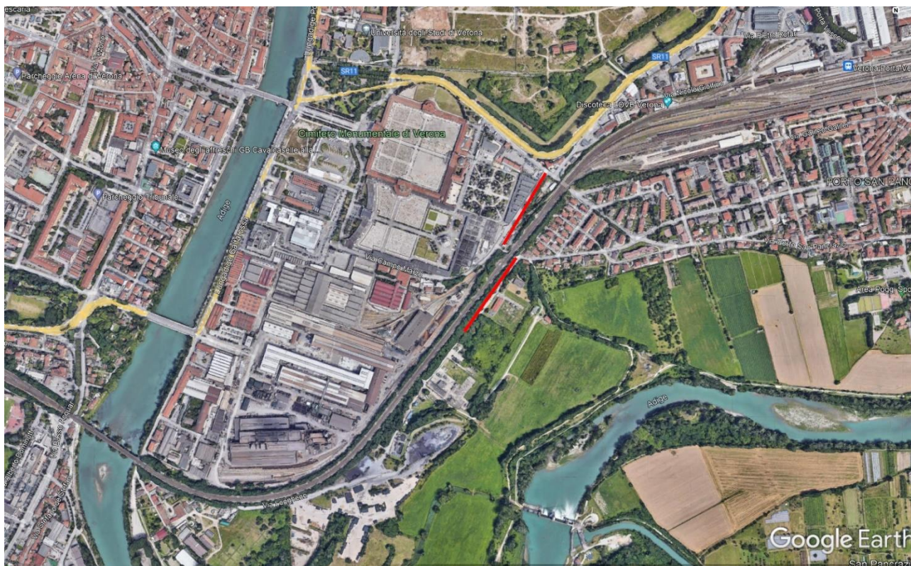
Figura 33. Localizzazione delle tomografie elettriche e delle stese di sismica tomografica a rifrazione (Campagna indagini ITAFERR 2021)
