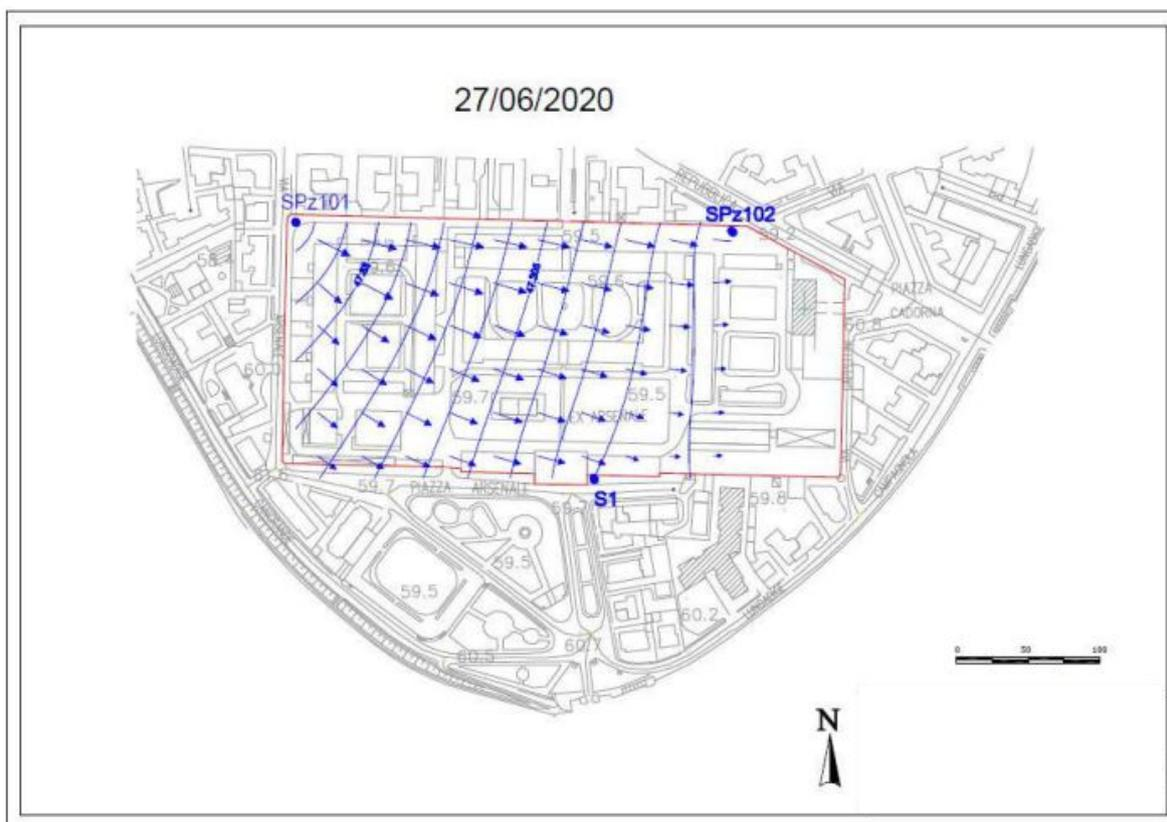
Figura 3. Ubicazione dei pozzi di monitoraggio e piezometria al 27/06/2020
