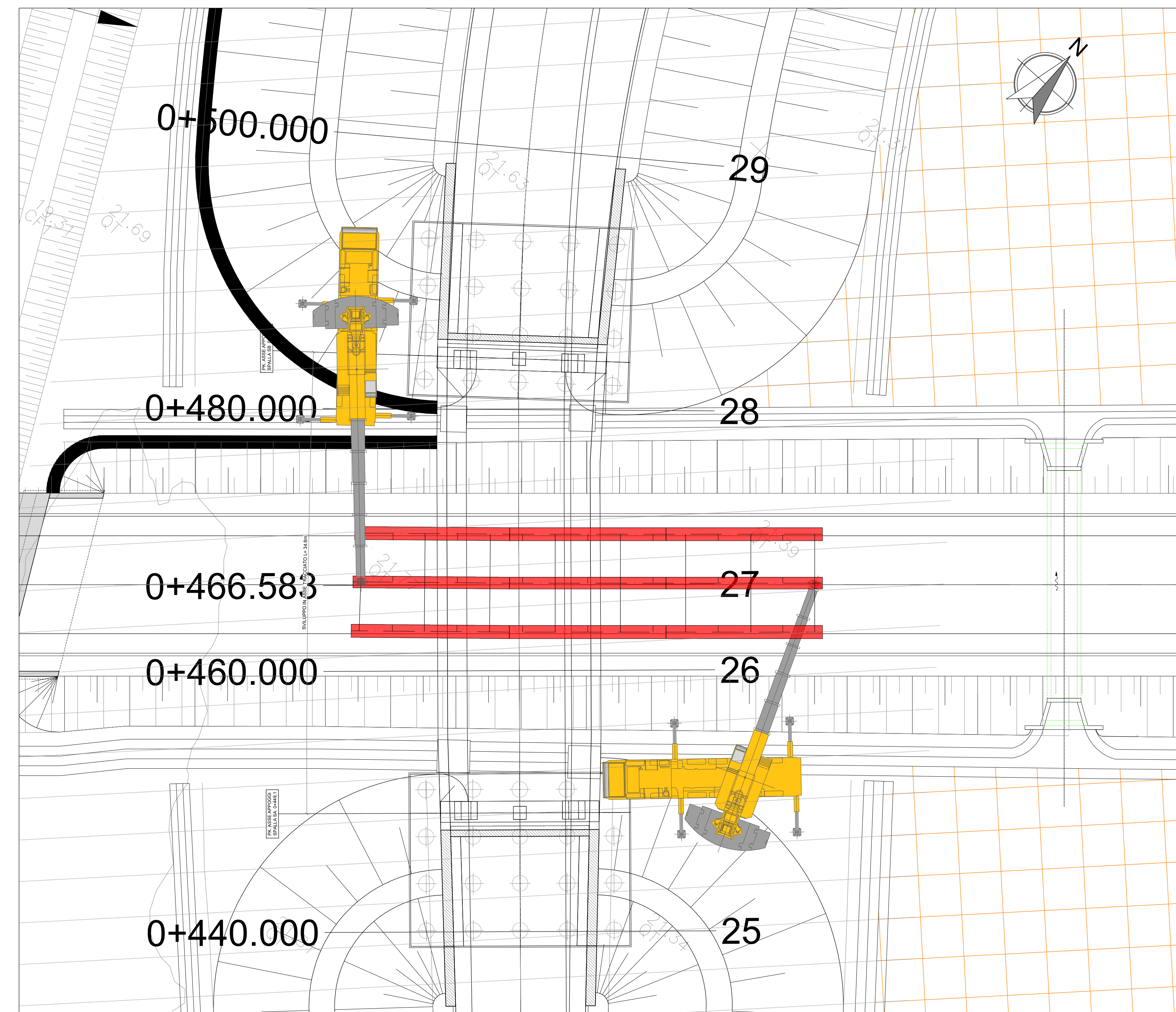
PLANIMETRIA MONTAGGIO IMPALCATO Scala 1: 200
