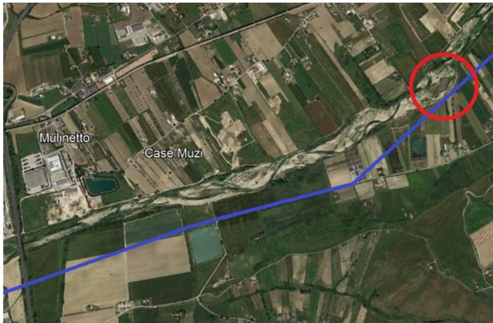
Figura 2-55: Tratto critico (Cerchio Rosso) del tracciato di progetto per erosione spondale
