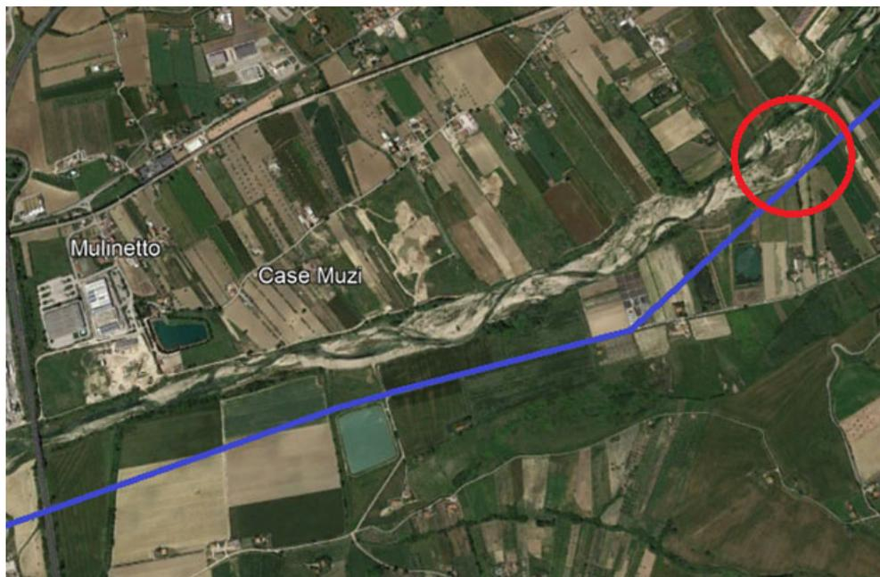
Figura I-3: Tratto critico (Cerchio Rosso) del tracciato di progetto per erosione spondale
