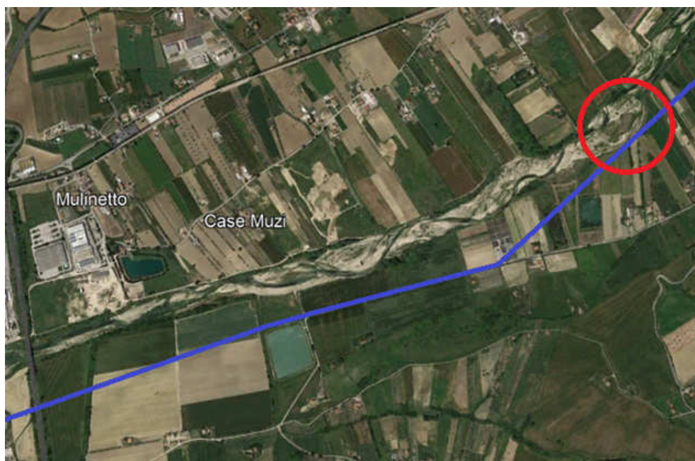
Figura 2-11: Tratto critico (Cerchio Rosso) del tracciato di progetto per erosione spondale
