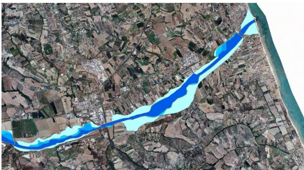
Figura 2-2: Perimetrazioni pericolosità idraulica PSDA lungo il tratto del Fiume Tordino oggetto di studio
