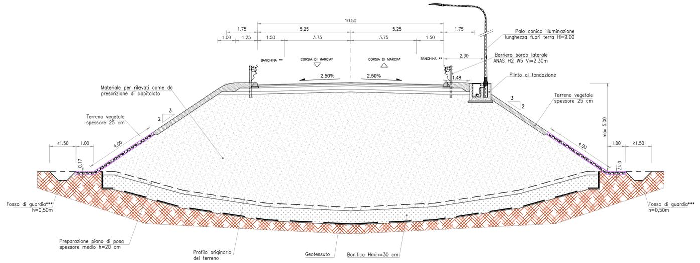
SEZIONE TIPO RILEVATO IN RETTIFILO
