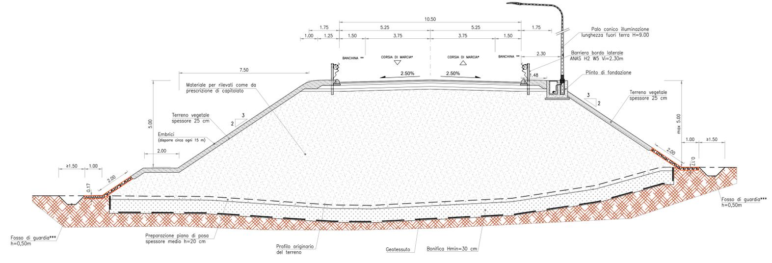
SEZIONE TIPO RILEVATO IN RETTIFILO
