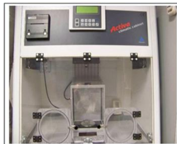
Camera di condizionamento filtri con bilancia analitica di precisione
