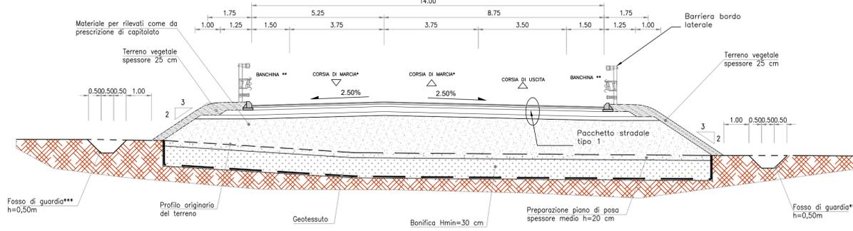
SEZIONE TIPO RILEVATO IN CURVA - STRADA Ctg. C1 (D.M 05/11/2001)
