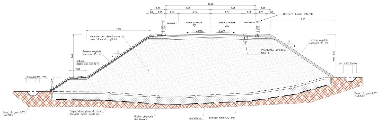
SEZIONE TIPO RILEVATO IN RETTIFILLO CON CORSIA DI USCITA - STRADA Ctg. C1 (D.M 05/11/2001)
