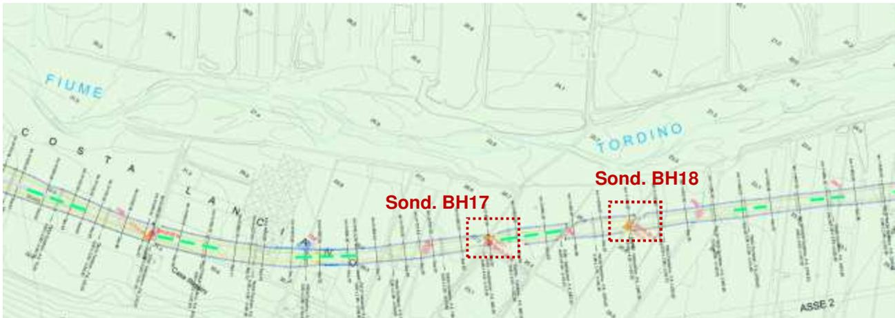
Figura 2-70. Individuazione punti di campionamento e sondaggi acque sotterranee effettuate nel 2021 in fase preliminare alla progettazione definitiva in oggetto
