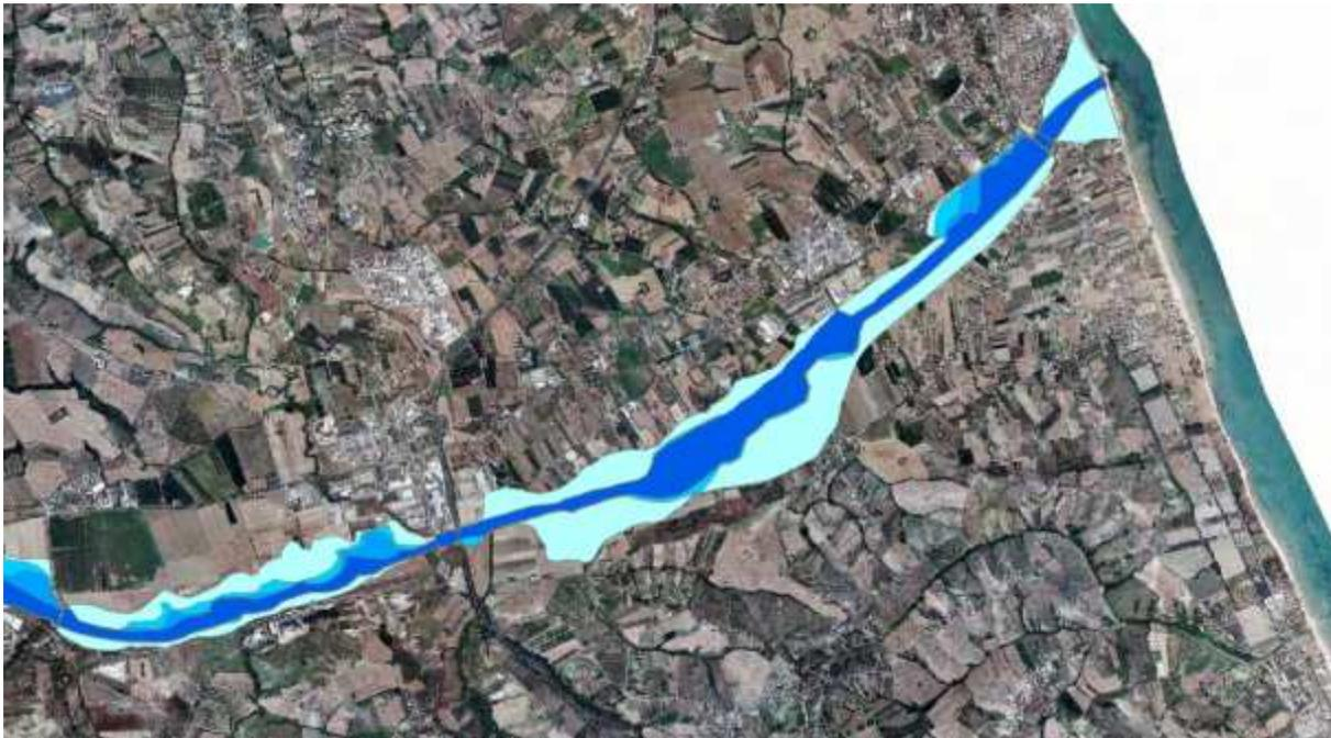
Figura 2-65 Pericolosità idraulica in corrispondenza del Fiume Tordino
