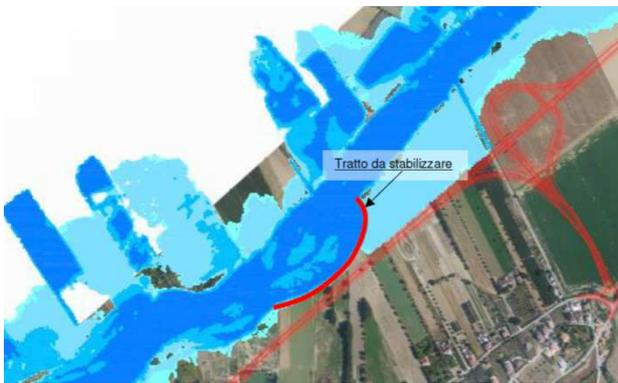
Figura 2-17. Sponda destra del Tordino oggetto di stabilizzazione e protezione dall'azione erosiva
