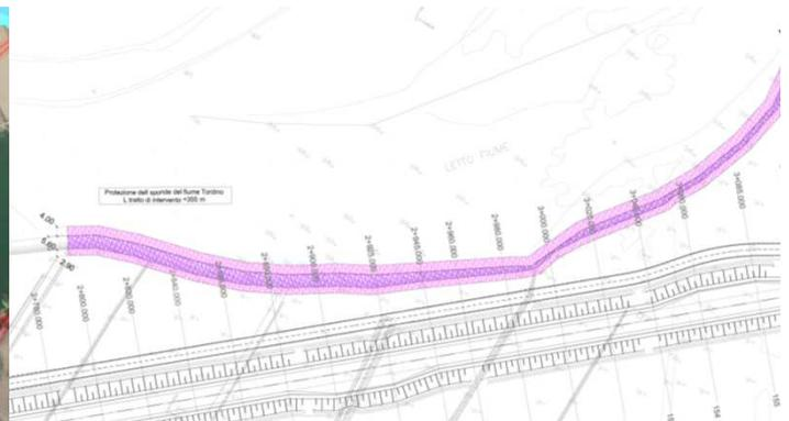
Figura 2-18 .Planimetria intervento protezione in massi naturali per protezione sponda destra fiume Tordino
