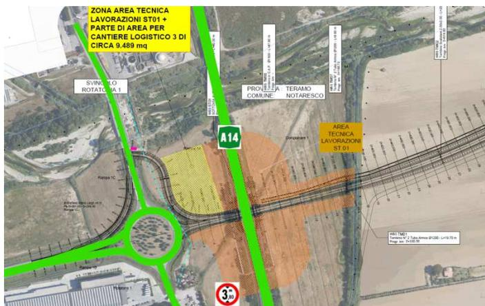
Figura 2-22. Stralcio elaborato T00CA00CANPP02\_A: Planimetria con ubicazione aree di cantiere
