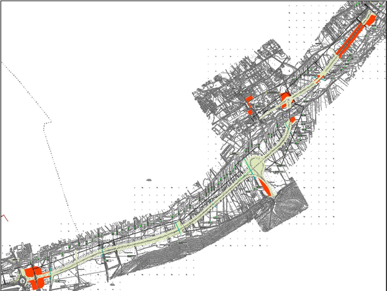
Figura 2-30. Stralcio planimetrico con evidenziazione degli inerbimenti (verde) ripristino aree cantiere (arancione)
