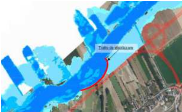
Figura 9-10. Sponda destra del Tordino oggetto di stabilizzazione e protezione dall'azione erosiva
