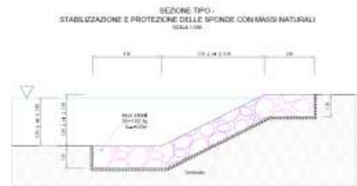
Figura 9-12. Sezione tipo della protezione in massi naturali per la protezione della sponda destra
