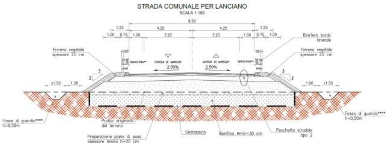
Figura 7-7. Sezione Tipo deviazione viabilità Comunale Coste Lanciano
