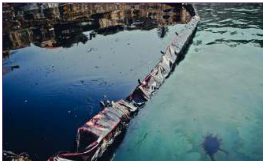
Figura 23 - Panne a cortina in assetto operativo
