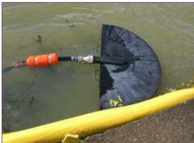
Figura 35 - Skimmer ad aspirazione
