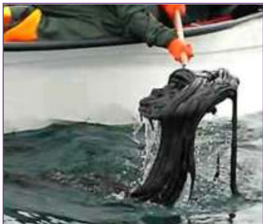
Figura 43 - Utilizzo di un guadino per la raccolta di idrocarburi molto viscosi
