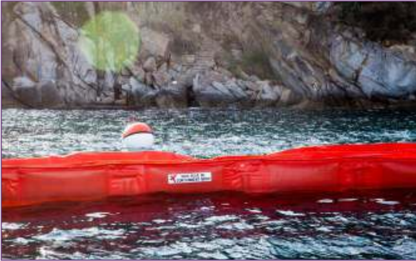
Figura 25 - Panne a cortina con galleggiante solido
