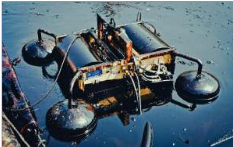
Figura 36 - Skimmer ad adesione a tamburo
