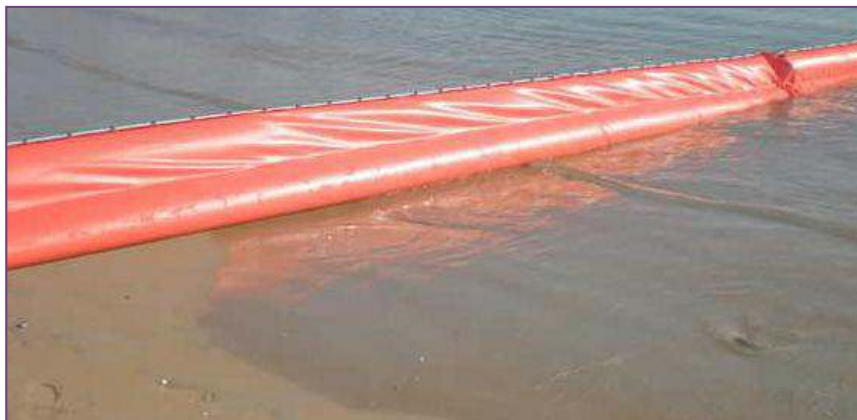
Figura 29 - Panne intertidali in assetto operativo.
