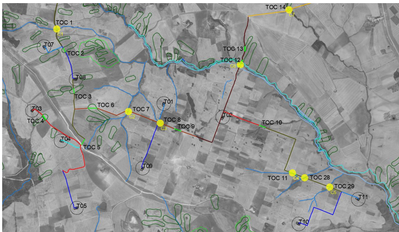
Attraversamento reticolo idrografico mediante posa in TOC – Interferenze da C1 a C7
