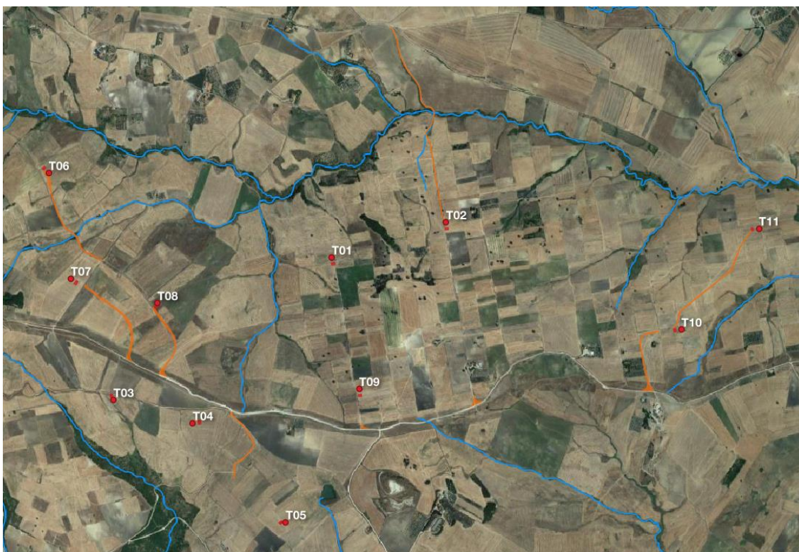
Reticolo idrografico – Piazzole e viabilità di cantiere
