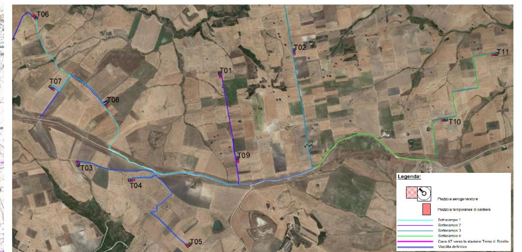
Le distanze sopra riportate sono coerenti con le Linee guida del D.G.R. n. 621/2011: dato l'aerogeneratore scelto (altezza al mozzo pari a 125 m, diametro rotore pari a 162 m), la fascia di rispetto prevista dalle Linee guida ha ampiezza pari a 1.536 m. Considerato che l'aerogeneratore più prossimo dista oltre 2 km dai centri abitati di San Giuliano di Puglia e Santa Croce di Magliano, l'impianto è da ritenersi esterno alla fascia di rispetto.
