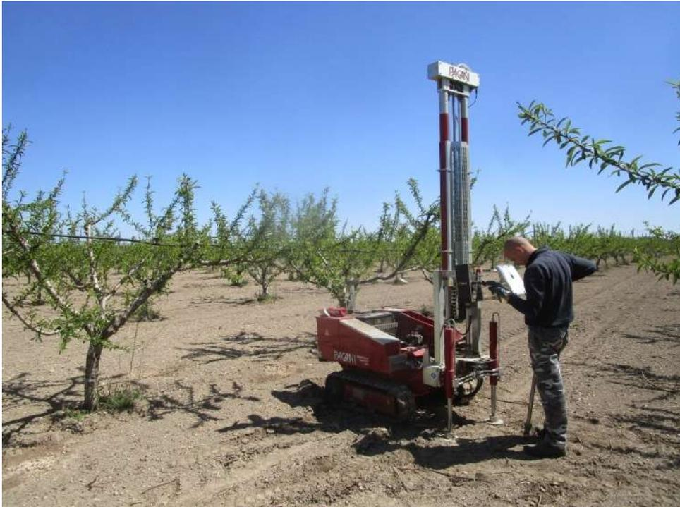
Esecuzione prova penetrometrica dinamica continua DPSH n.2
