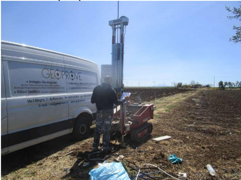
***Prova penetrometrica dinamica continua DPSH n.2***
