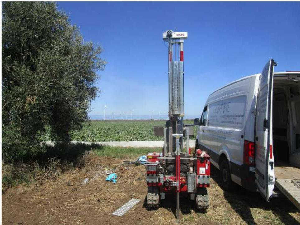
Esecuzione prova penetrometrica dinamica continua DPSH n.1
