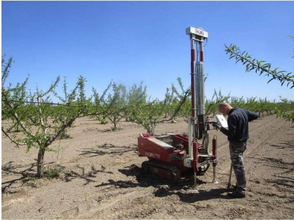
Esecuzione prova penetrometrica dinamica continua DPSH n.2
