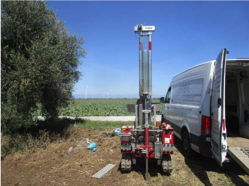
**Esecuzione prova penetrometrica dinamica continua DPSH n.1**
