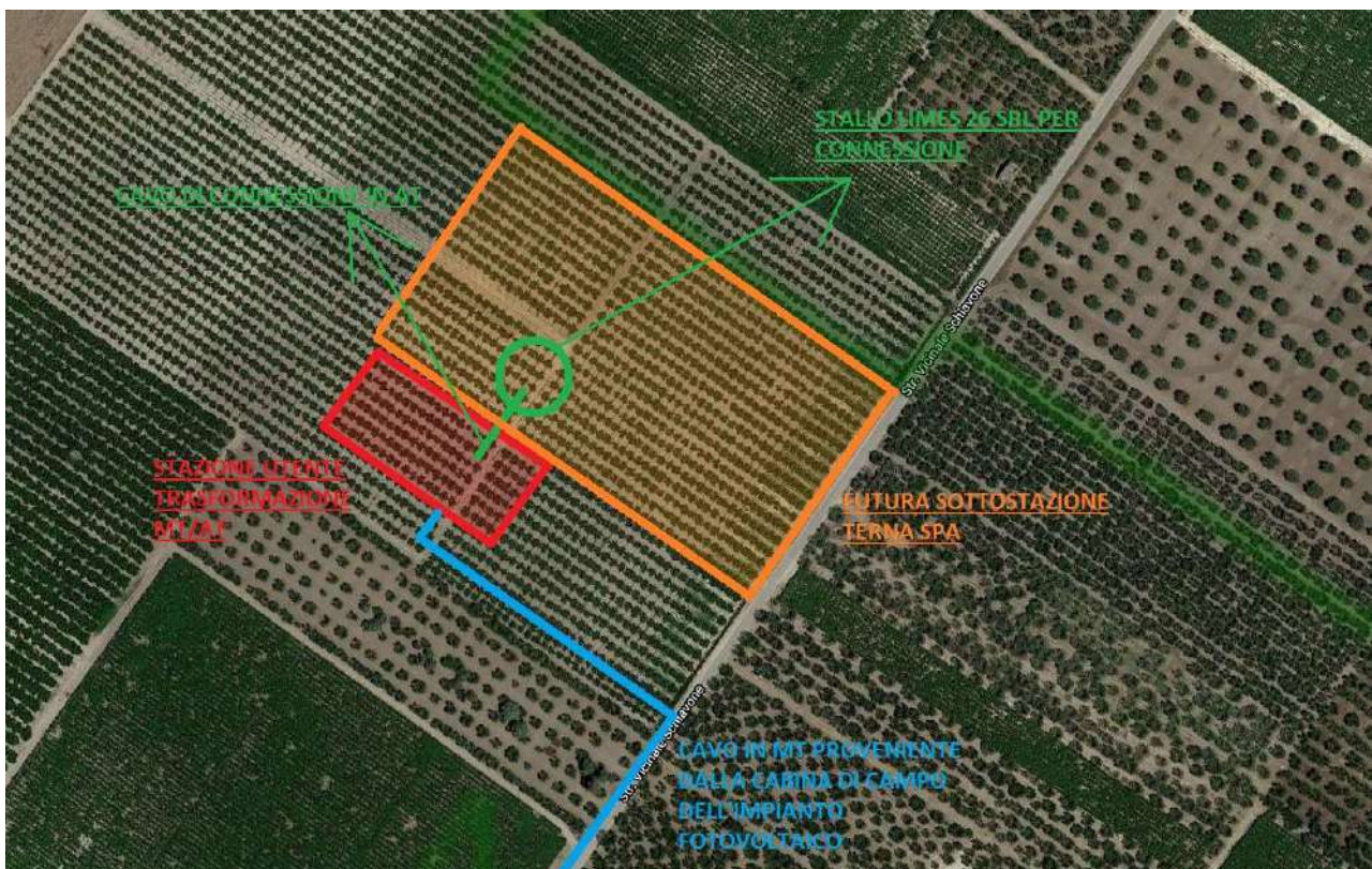
Illustrazione 2.3: Vista d'insieme della stazione utente con collegamento cavo AT (in verde)
