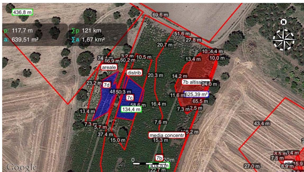
Fig. 12. Esempio di posizionamento sul terreno con Measure Map Pro delle singole concentrazioni di materiali
