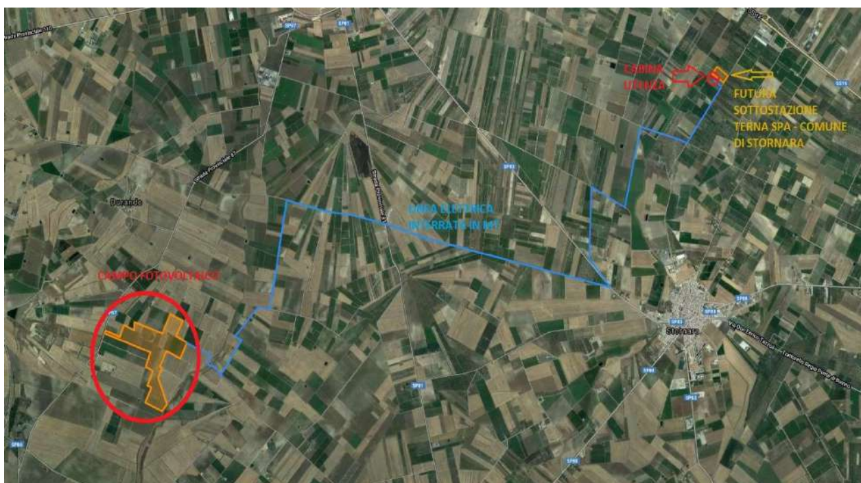
Illustrazione 4.1: Vista d'insieme dell'impianto con collegamento cavo MT (in blu)
