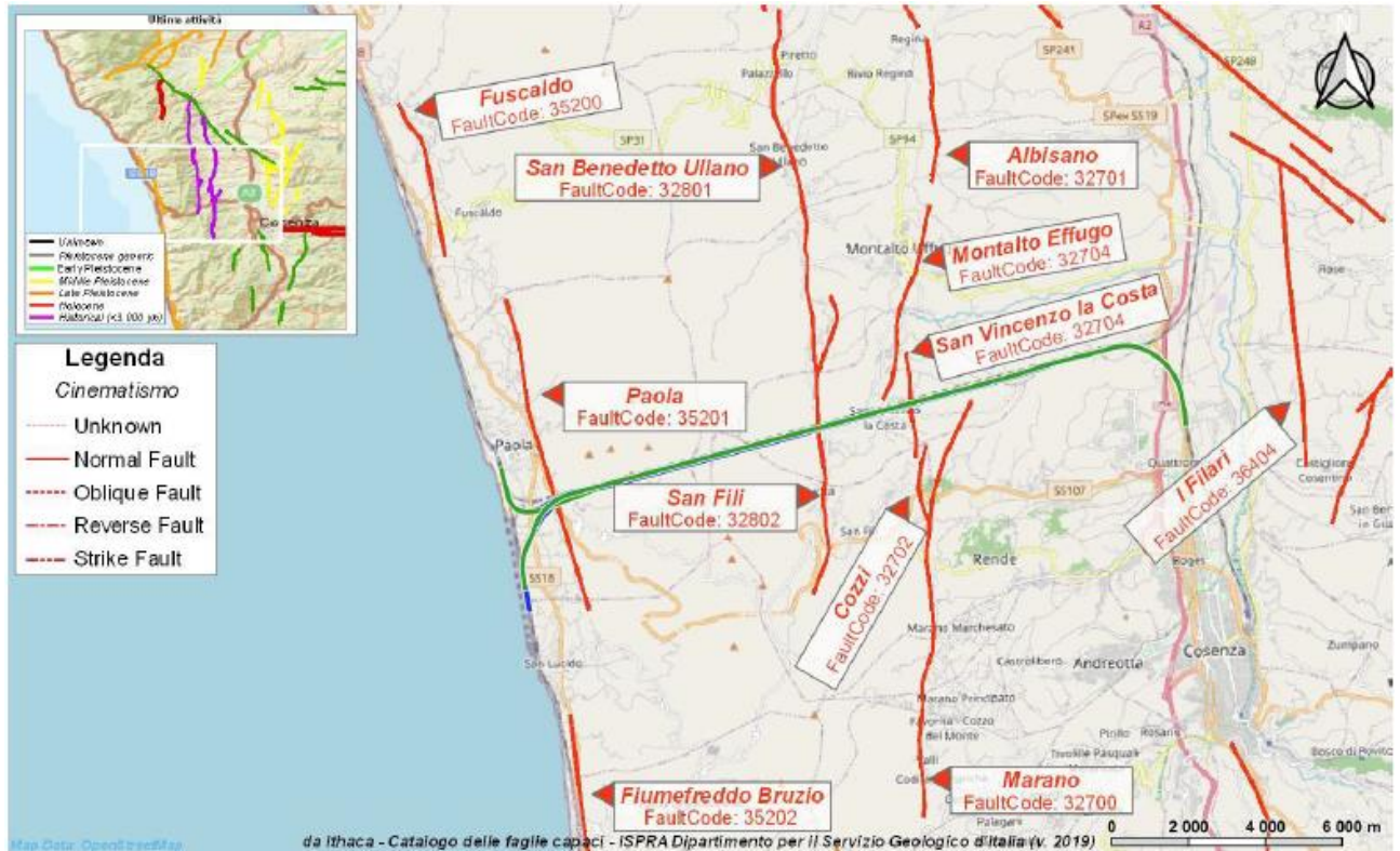
Figura 2-55. Stralcio cartografico dell'area di interesse, riprodotto in scala 1:200000, con indicazione schematica della tratta in progetto (verde-blu), e delle faglie capaci (in rosso)
