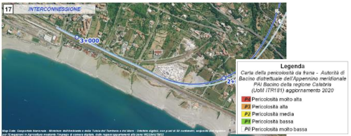
Figura 2-52. Stralcio della “Carta della Pericolosità da frana” del Piano Stralcio di Assetto Idrogeologico della Regione Calabria (PAI 2015 aggiornamento 2020) tratto km 2+000 ÷ 3+139, con individuazione del tracciato ferroviario in progetto (linea blu)
