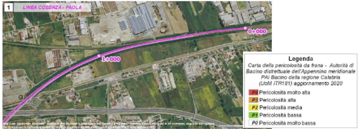
Figura 2-36. Stralcio della “Carta della Pericolosità da frana” del Piano Stralcio di Assetto Idrogeologico della Regione Calabria (PAI 2015 aggiornamento 2020) tratto km 0+000 ÷ 1+900, con individuazione del tracciato ferroviario in progetto (linea magenta)
