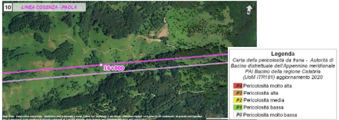
Figura 2-45. Stralcio della “Carta della Pericolosità da frana” del Piano Stralcio di Assetto Idrogeologico della Regione Calabria (PAI 2015 aggiornamento 2020) tratto km 15+000 ÷ 16+700, con individuazione del tracciato ferroviario in progetto (linea magenta)
