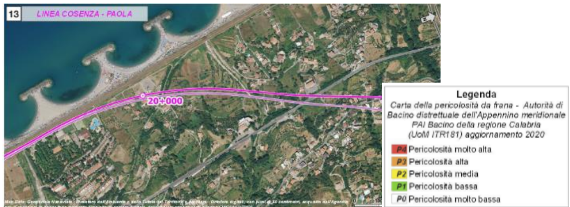
Figura 2-48. Stralcio della “Carta della Pericolosità da frana” del Piano Stralcio di Assetto Idrogeologico della Regione Calabria (PAI 2015 aggiornamento 2020) tratto km 19+000 ÷ 20+500, con individuazione del tracciato ferroviario in progetto (linea magenta)
