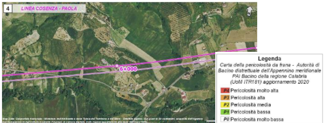
Figura 2-39. Stralcio della “Carta della Pericolosità da frana” del Piano Stralcio di Assetto Idrogeologico della Regione Calabria (PAI 2015 aggiornamento 2020) tratto km 5+100 ÷ 6+900, con individuazione del tracciato ferroviario in progetto (linea magenta)
