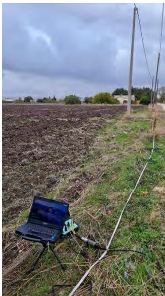
**Fig. 1.3.5.16 - Acquisizione sismica M.A.S.W. 6.**
