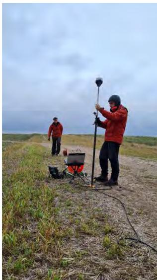
**Fig. 1.3.5.13 - Acquisizione sismica M.A.S.W. 5.**
