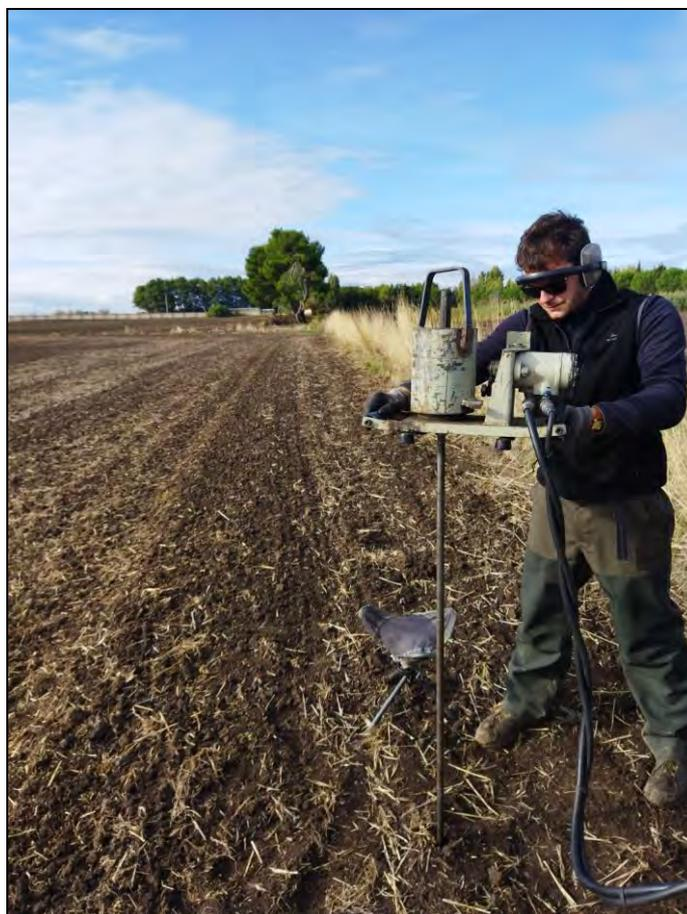
*Fig. 1.1.4.7 – Esecuzione indagine penetrometrica dinamica media - D.P.M. 4.*
