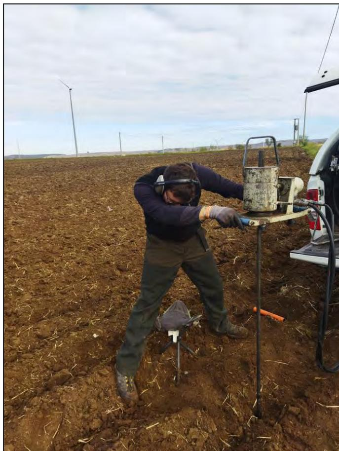
**Fig. 1.1.4.5 – Esecuzione indagine penetrometrica dinamica media - D.P.M. 3.**
