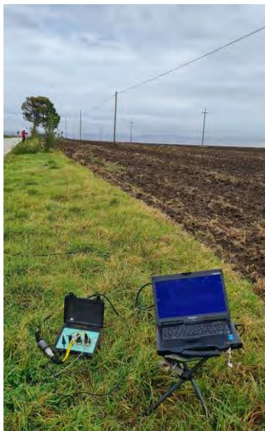
**Fig. 1.3.5.4 - Acquisizione sismica M.A.S.W. 2.**
