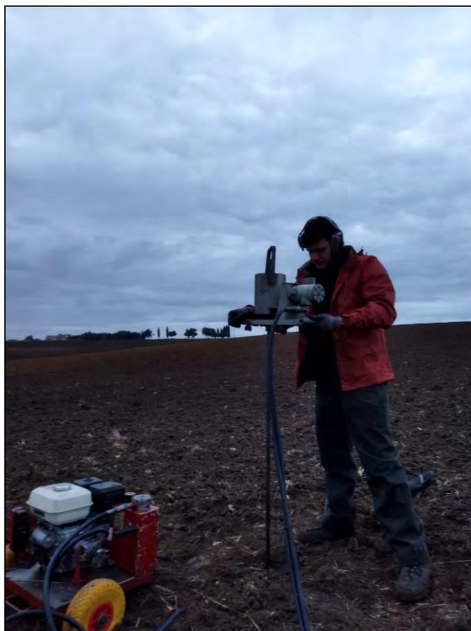
*Fig. 1.1.4.1 – Esecuzione indagine penetrometrica dinamica media - D.P.M. 1.*
