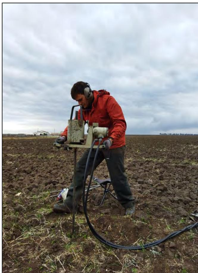
*Fig. 1.1.4.11 – Esecuzione indagine penetrometrica dinamica media - D.P.M. 6.*
