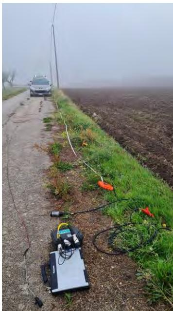
**Fig. 1.3.5.7 - Acquisizione sismica M.A.S.W. 3.**
