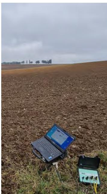
**Fig. 1.3.5.1 - Acquisizione sismica M.A.S.W. 1.**
