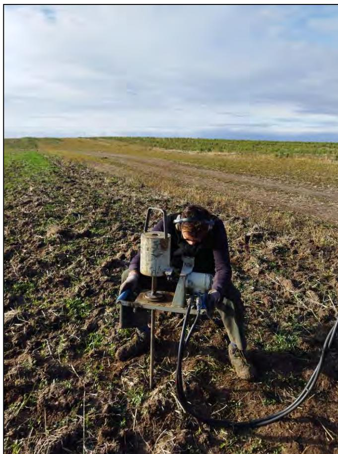
**Fig. 1.1.4.9 – Esecuzione indagine penetrometrica dinamica media – D.P.M. 5.**
